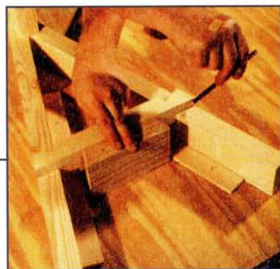
Брусок-шаблон со сторонами, запиленными под нужным углом, позволяет одинаково разметить соединения на всех стыках.
