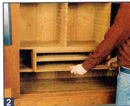
Для хранения длинных предметов, не помещающихся в маленьких ящиках, между полками можно вставить коробку с двумя большими выдвижными ящиками.
